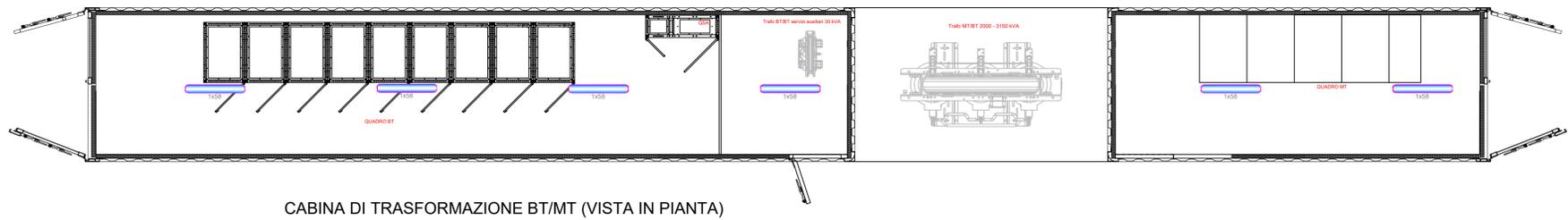
CABINA DI TRASFORMAZIONE BT/MT (VISTA IN PIANTA)
