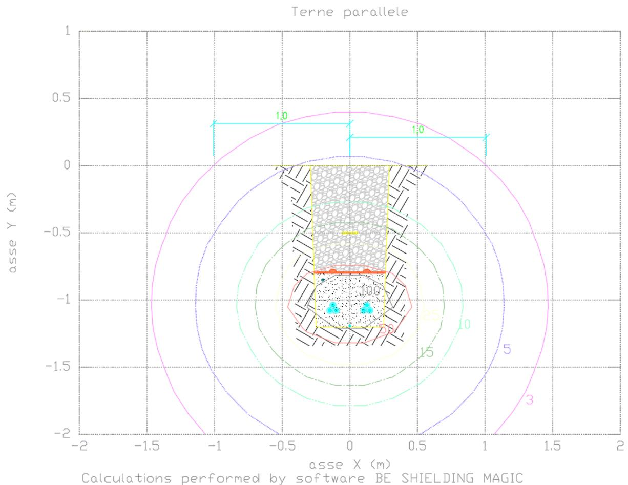
Figura 1 – Calcolo dei livelli di campo magnetico per i 2 cavidotti interrati nel tratto FV Rotello 1 - FV Rotello 2
