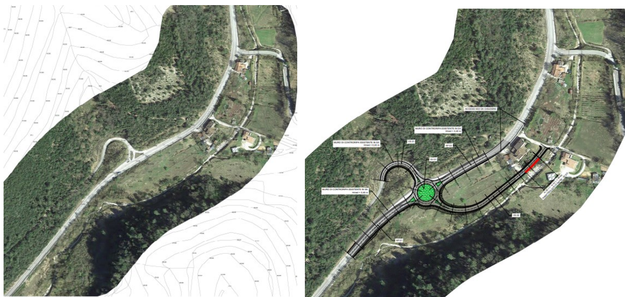
Figura 4: Stato di fatto (sinistra) e planimetria di progetto (destra) Molinaccio 2 (Fonte: Allegati alla Lista di controllo)
