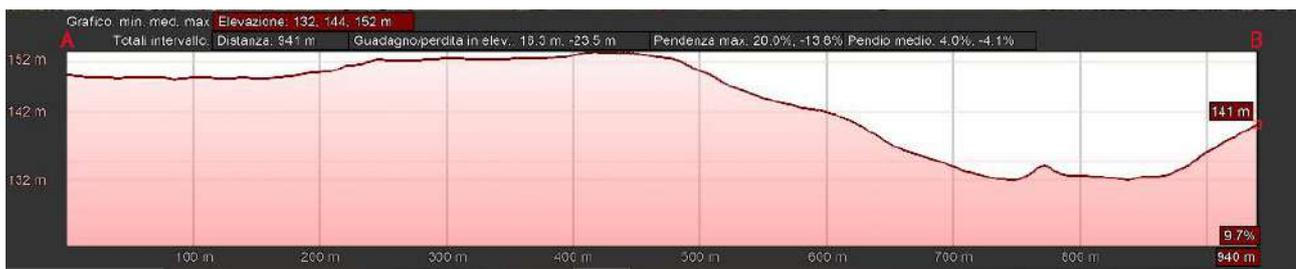
Figura 69 - Sezione morfologica del terreno del punto di presa 7a - Regio Tratturello Lavello - Minervino
