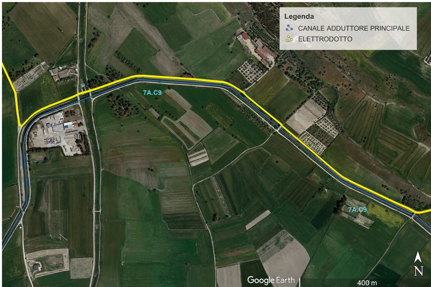
ALL 01 - Interferenza tra il tracciato dell'elettrodotto e il Canale Adduttore Principale del Flumendosa (Codice SIMR 7A.C9)
