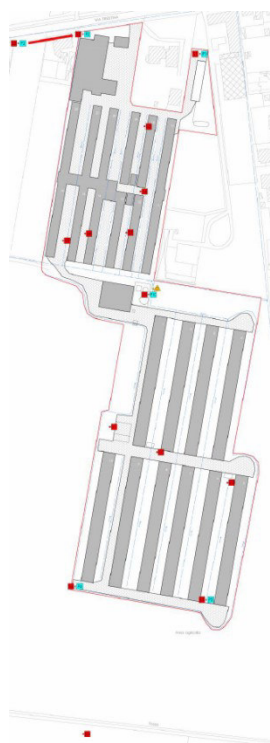
Figura 10 Ubicazione dei sondaggi effettuati. In rosso i 14 sondaggi a 4 m di profondità; in azzurro i 5 sondaggi attrezzati a piezometro; in giallo l'analisi dei sedimenti della scolina (Fonte: Piano di Caratterizzazione – risultanze
