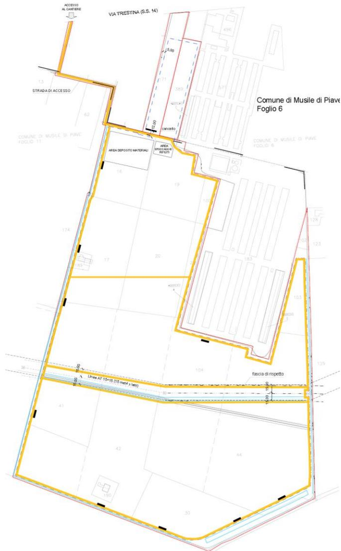
*Planimetria di cantiere; in arancione la viabilità di cantiere, mantenuta anche in fase di esercizio dell'impianto a fini manutentivi*
