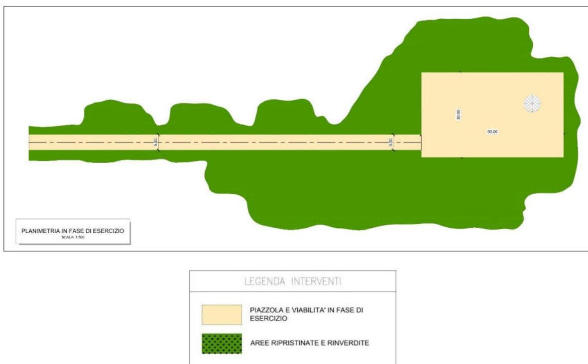
Figura 3.29: Struttura tipo di una piazzola permanente al termine della realizzazione (Rif. 2799\_5298\_GIUD\_PD\_T07\_Rev0\_TIPOLOGICO PIAZZOLA DEF.TEMP).
