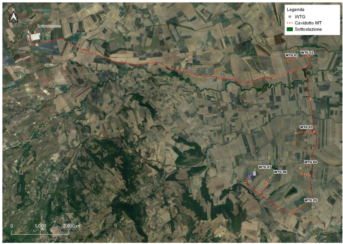
Figura 7 - layout impianto definitivo a n.7 aerogeneratori
