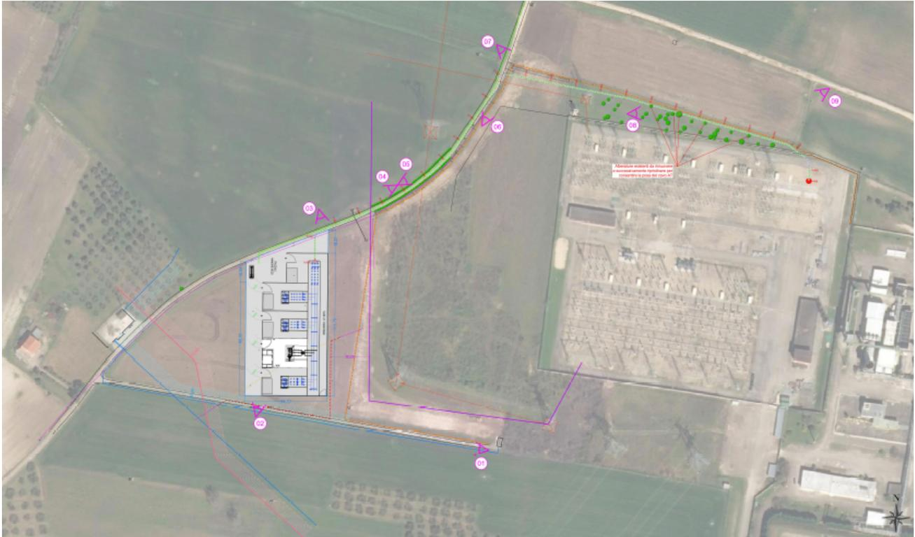
*Planimetria generale nuova cabina AT/MT e collegamento in cavo AT – Planimetria di progetto su rilievo*
