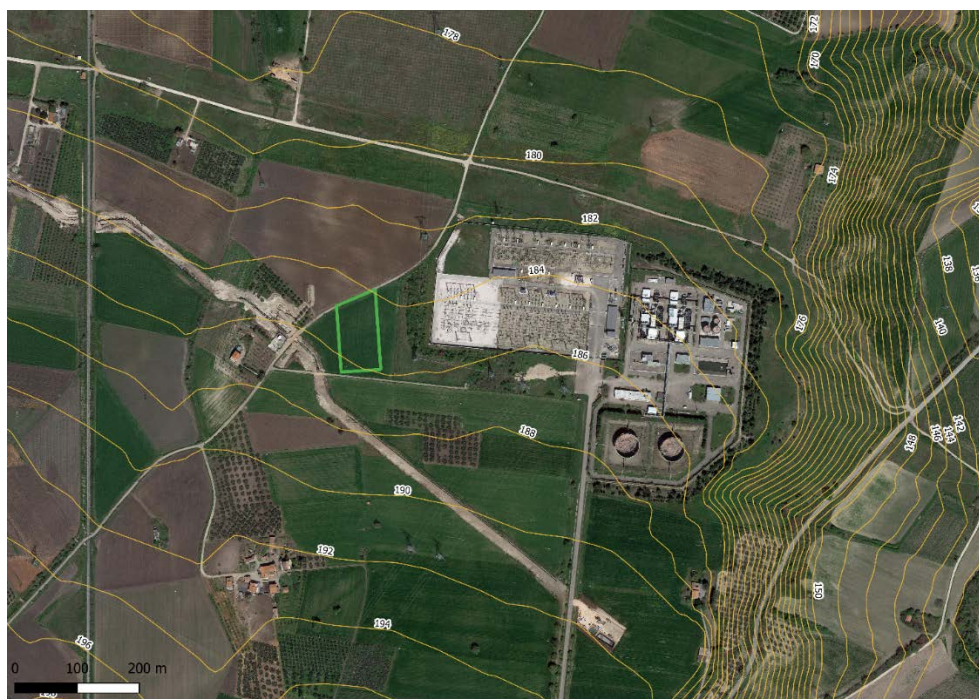
Figura 2: Curve di livello con dettaglio 2 m sovrapposte alla Stazione Elettrica Terna di Larino ed all'area per la realizzazione della stazione di elevazione (poligono verde in figura)
