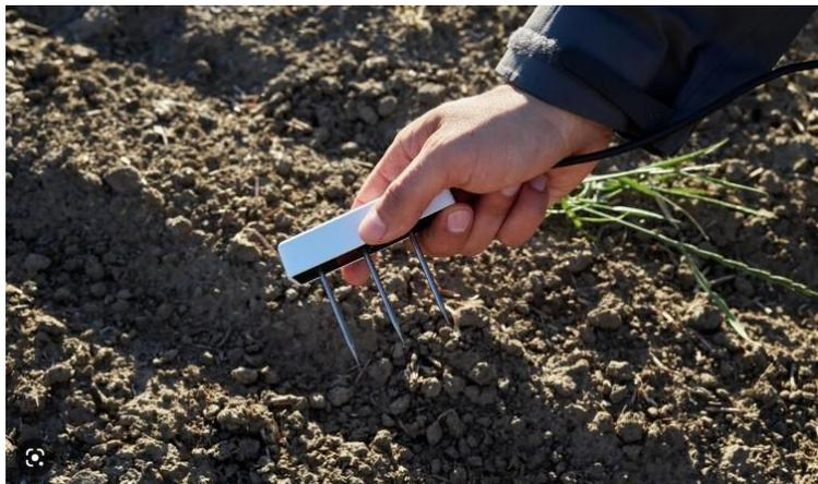
Figura 7 - Sensore TEROS12 (Meter) da inserire per il monitoraggio delle colture dell'ulivo e degli alberi della famiglia del tartufo.
