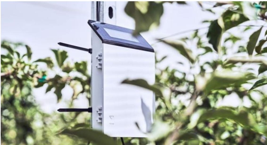
Figura 5 - Datalogger ZL6 (Meter) con 6 canali di ingresso da inserire in pieno campo.
