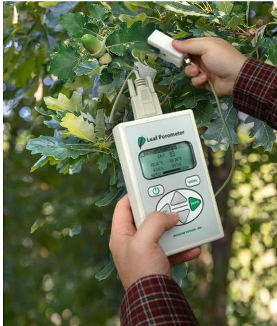
Figura 10 - Sensore LEAF-POROMETER dell'impianto di arboricoltura di essenze tartufigene.
