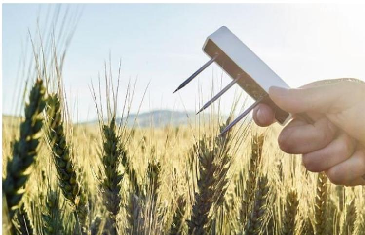
Figura 8 - Sensore TEROS12 (Meter) da inserire per il monitoraggio delle colture impiantate tra le interfile dei tracker.
