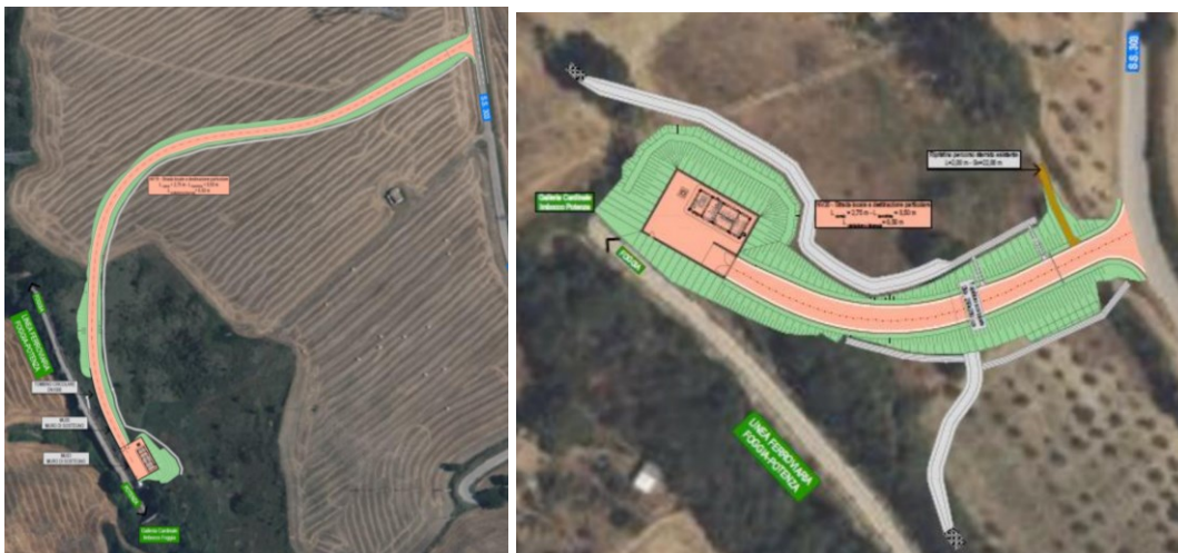
Figura 3: Soluzione imbocco galleria Cardinale lato Foggia (Sinistra) e lato Potenza (destra) (Fonte: Allegati alla Lista di controllo)
