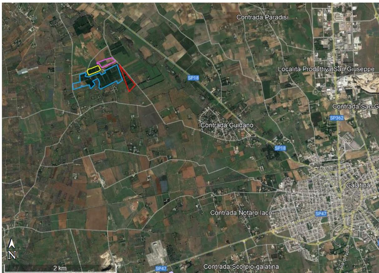
Figura 2.3: Localizzazione dell'impianto. In blu la sezione A, in giallo la sezione B, in magenta la sezione C e in rosso la sezione D.
