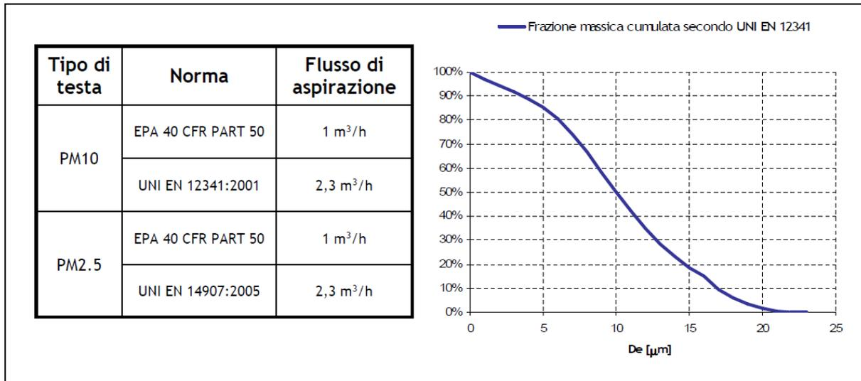
Fig. 06: Tipologia di Teste di Campionamento – Normativa di riferimento
