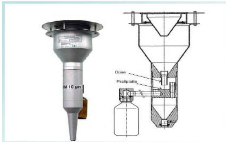
*Fig. 05: Testa di campionamento per il prelievo del particolato*
