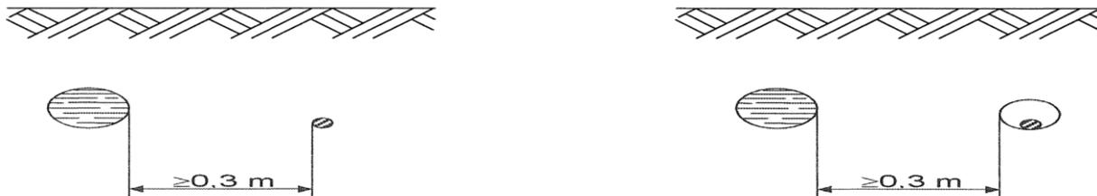
Incroci e parallelismi tra cavi di energia in tubazione e tubazioni di gas con densità non superiore a 0,8 non drenate con pressione massima di esercizio >5 Bar
