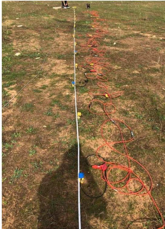
Foto Stendimento di sismica a rifrazione Rz1 e Mw1.
