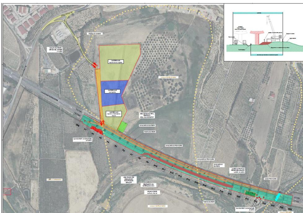
Fig. 3 – Planimetria area di cantiere (Fonte: Allegato alla Lista di controllo Planimetria aree di cantiere e viabilità di servizio)
