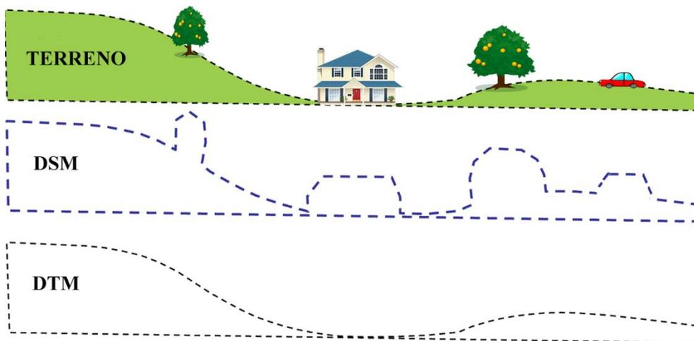
Figura 31 - Differenza tra DTM e DSM<sup>5</sup>
