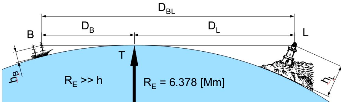
Figura 27 - Distanza massima di visibilità tra faro e osservatore<sup>2</sup>
