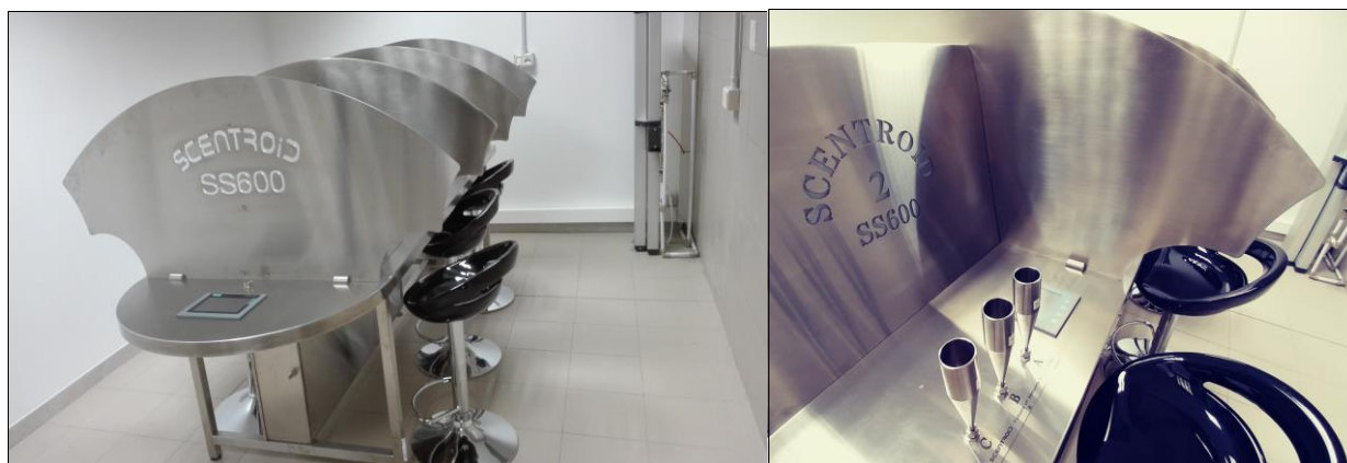
Figura 5.1.1.1-1 Tavolo Olfattometrico Sartec – SCENTROID SS600.
