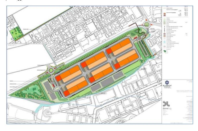
La proposta di progetto proposta da Noviglio Datacenter MXP s.r.l. ha profondamente rivisto le superfici coperte produttive e ridotto i volumi attraverso l'ottimizzazione degli spazi interni, al fine di ridurre costi e tempi di realizzazione oltre che ad un migliore approccio in ottica "green", con maggiori superfici filtranti e riduzione delle aree impermeabili.
