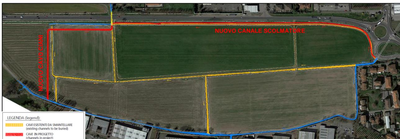
Figura 13 – Configurazione di progetto rete canali
