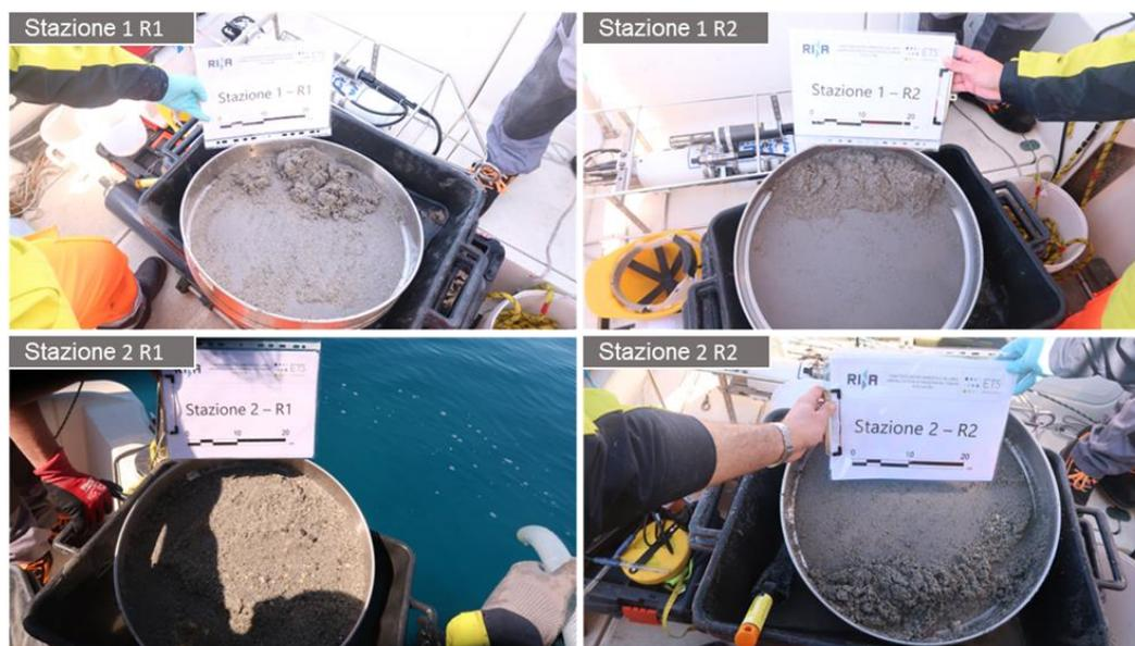
Figura 6.15: Setacci con relativo materiale sedimentario trattenuto a termine della setacciatura effettuata in campo. Dall'alto verso il basso: Stazione di campionamento 1, Stazione di campionamento 2 e le relative due repliche (R)
