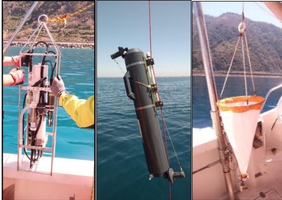
**Figura 3.2:** Sonda multiparametrica CTD SBE 19plus (a sinistra) bottiglia Niskin (al centro) e retino da zooplancton (a destra)
