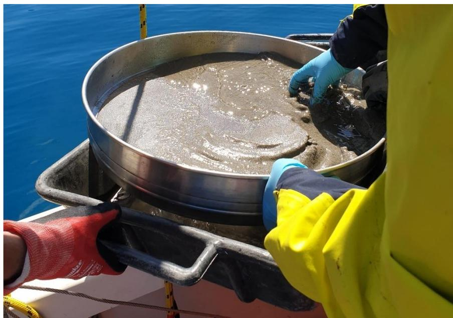
Figura 3.5: Setaccio in acciaio inossidabile mesh 0.5 mm
