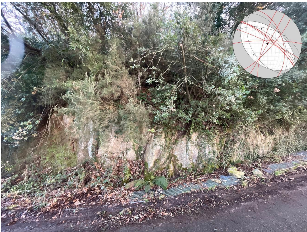
Figura 4.10. Stazione strutturale 3 ( 38^{\circ} 14' 59'' N -015^{\circ} 45' 25'' E ). Le ciclografiche rosse nello stereogramma sono relative a piani di frattura, le ciclografiche nere indicano i piani di faglia e le frecce si riferiscono al cinematismo osservato.
