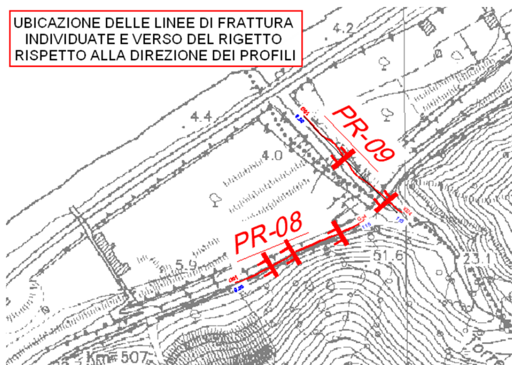
Figura 53 Ubicazione delle linee di frattura ipotizzate nell'area di valle
