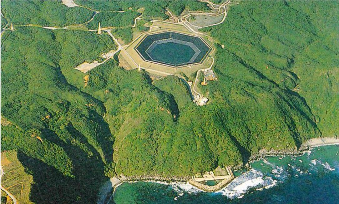
Figura 32: Immagine dell'installazione di Yanbaru, sull'isola di Okinawa in Giappone. Ad oggi l'unico impianto di pompaggio alimentato da acqua marina [fonte Hitachi Review Vol. 47 (1998)]
