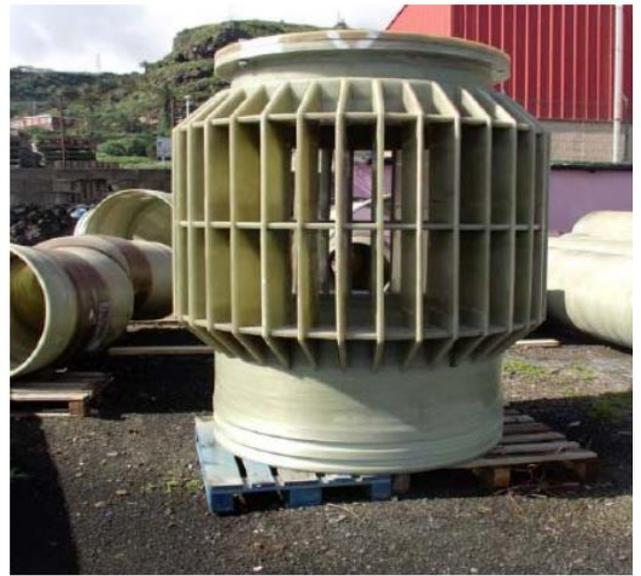
Figura 37: Esempio griglia di presa
