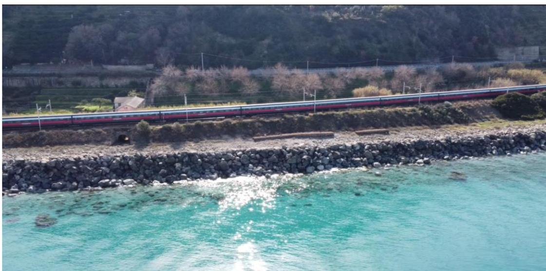
*Figura 5: inquadramento della zona con ausilio di aeromobile a pilotaggio remoto (APR). È ben visibile la scogliera radente lungo tutto il tratto di inserimento dell'opera.*
