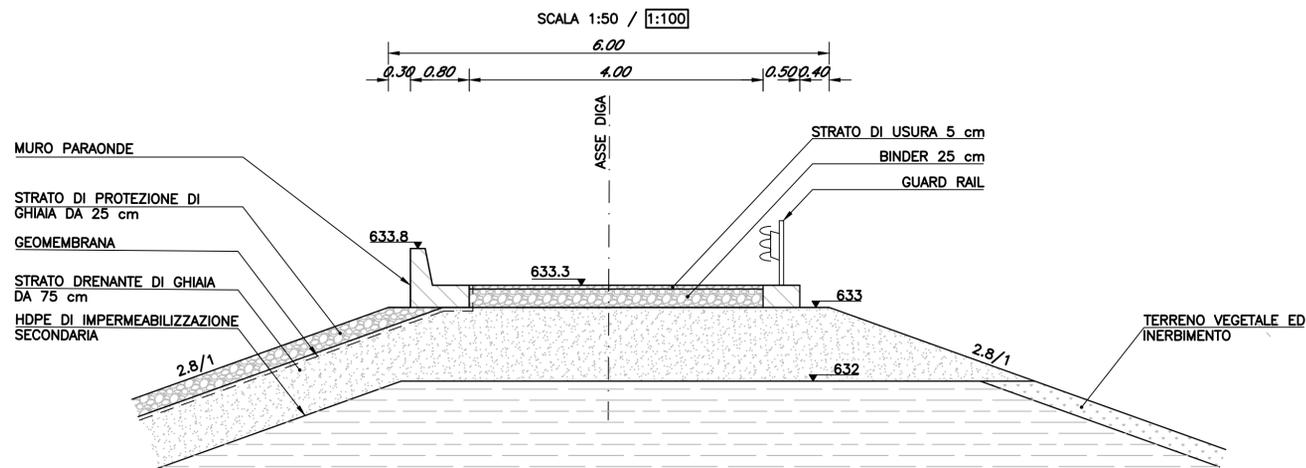
DETTAGLIO DEL MURO PARAONDE E CORDOLO
