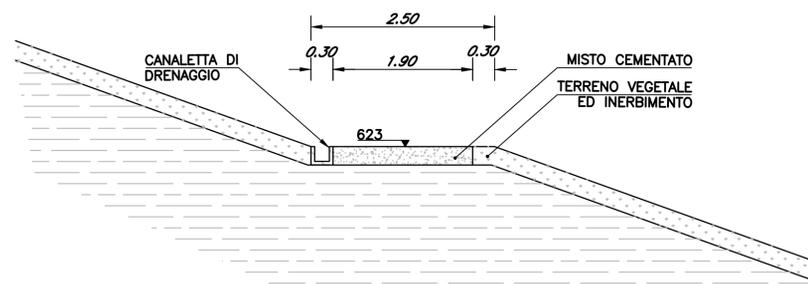
DETTAGLIO DELLA CANALETTA DI DRENAGGIO
