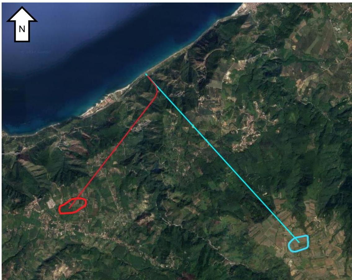
*Figura 3 - Potenziali aree individuate per la realizzazione del bacino di monte, con tracciati delle vie d'acqua. In rosso: opzione A. In ciano: opzione B*
