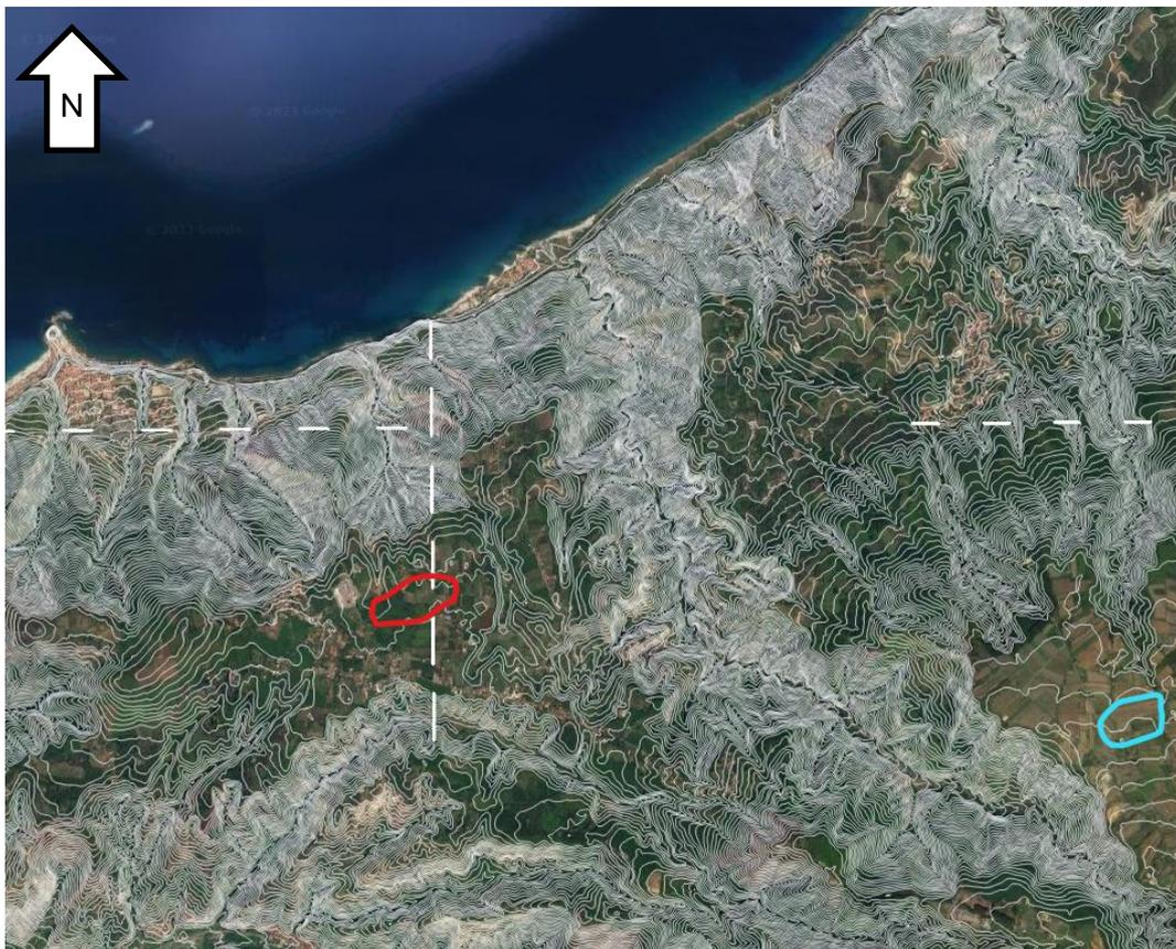
Figura 2 - Potenziali aree individuate per la realizzazione del bacino di monte. Linee bianche: curve di livello su ortofoto. In rosso: opzione A. In ciano: opzione B (il tratteggio bianco in mappa è dovuto ad un errore di overlap nel DTM disponibile sul geoportale della Regione Calabria)
