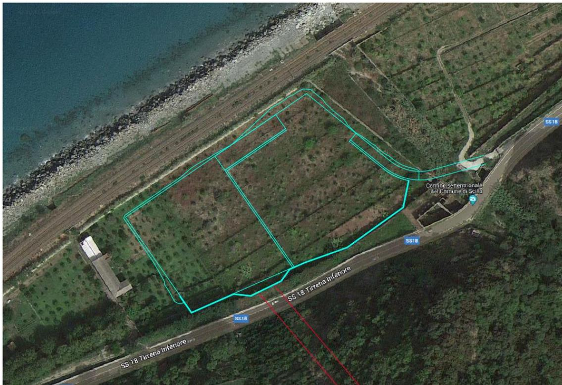
Figura 10 - Dettaglio dell'area dell'imbocco della galleria d'accesso (in rosso il tracciato della galleria d'accesso, in ciano il piazzale antistante l'imbocco). A destra è visibile il tratto di nuova viabilità che attraversa la fiumara presente.
