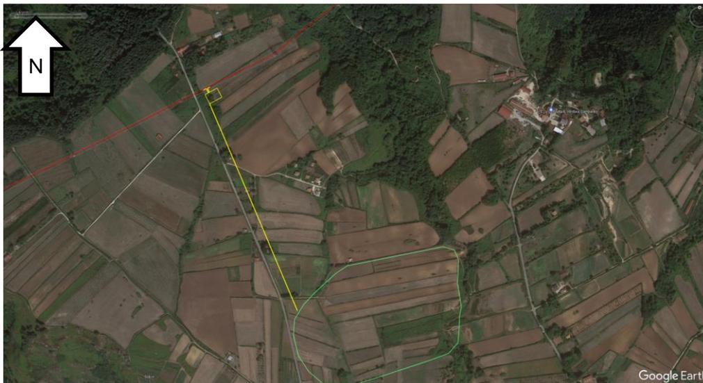
Figura 4 - Possibile soluzione di connessione alla RTN per l'opzione B. Poligono verde: bacino di monte. Linea gialla linea d'utenza. Rettangolo giallo: SSE d'utenza. Linea rossa: RTN a 380 kV.
