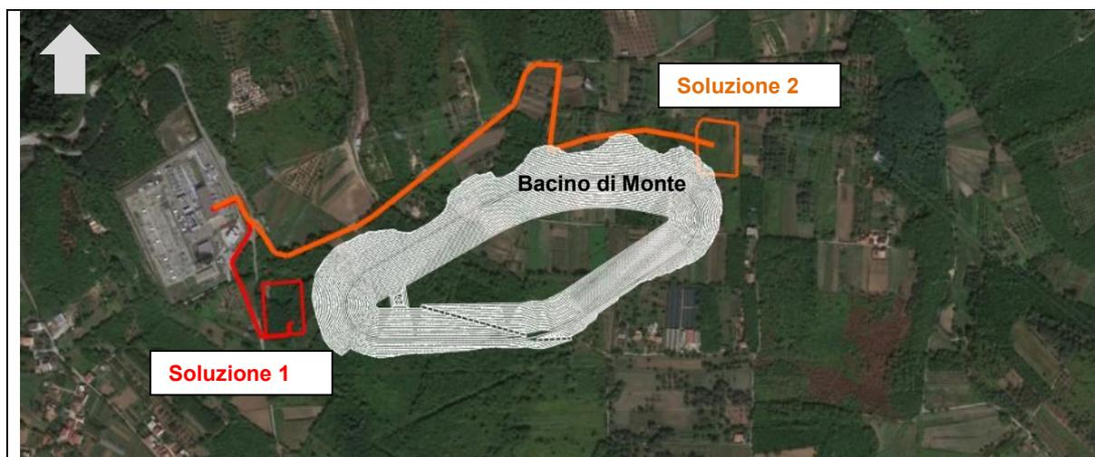
**La soluzione 1** prevede il posizionamento della Sottostazione di Utenza ad ovest del bacino di monte in prossimità di una strada esistente e nelle vicinanze della Stazione Elettrica di Scilla. La Connessione Utenza ha uno sviluppo lineare di circa 400 m ed è prevista in cavo interrato posto su sedime di strade esistenti.
