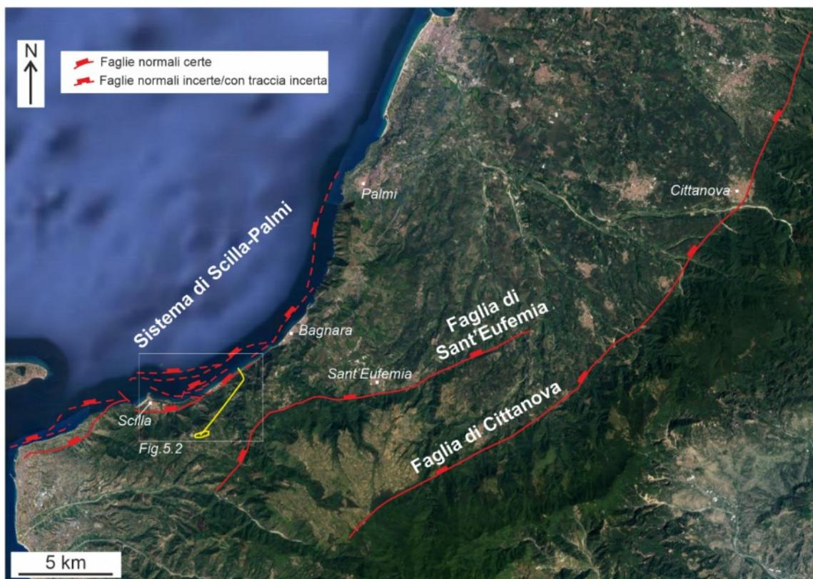
Figura 6.23: Principali Faglie attive nell'area di Studio. In giallo le opere a progetto
