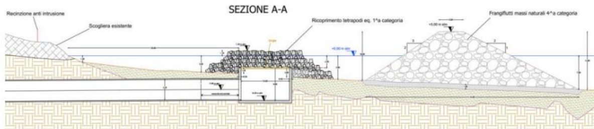
Figura 3.1: Sezione longitudinale dell'opera di presa e restituzione di valle (Doc. No. 1422-B-SA-D-02-0)
