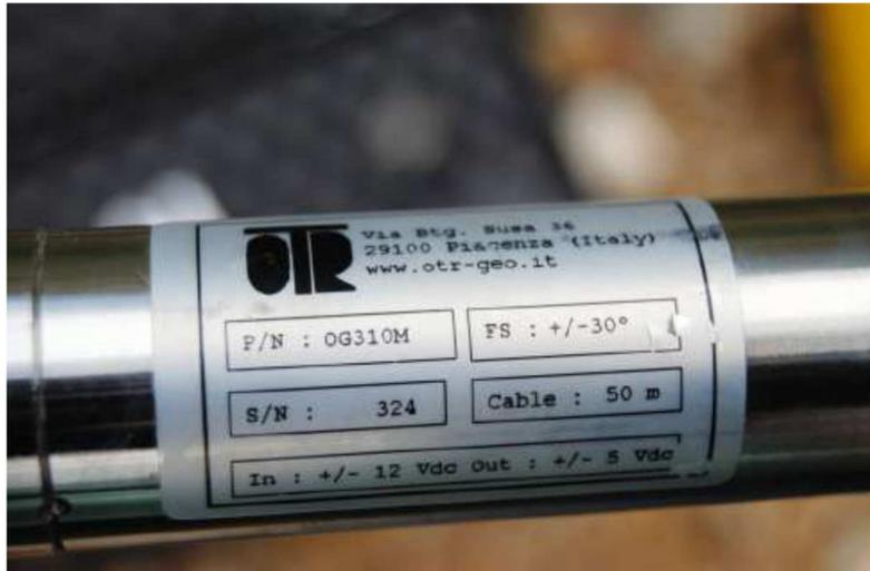
**Figura 2 – Sonda inclinometrica mobile**
