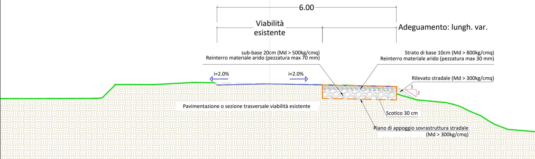
SEZIONE TIPICA VIABILITÀ ESISTENTE CON ADEGUAMENTO SUL LATO SINISTRO E DESTRO
