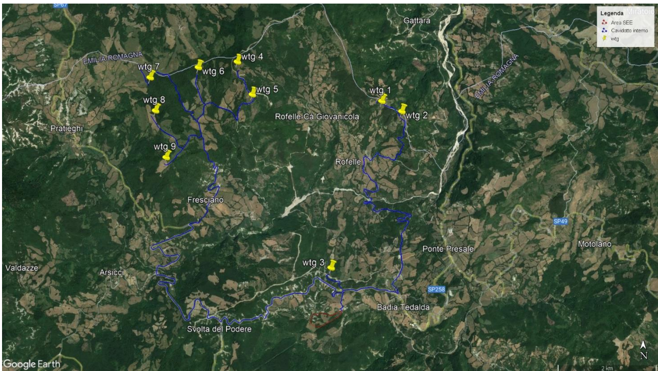
Figura 3: Inquadramento impianto, Cavidotto interno e Stazione SEE
