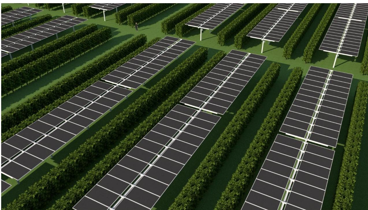
Figura 3- Schizzo dell'assetto impiantistico: un filare FV e due siepi ulivicole alternate
