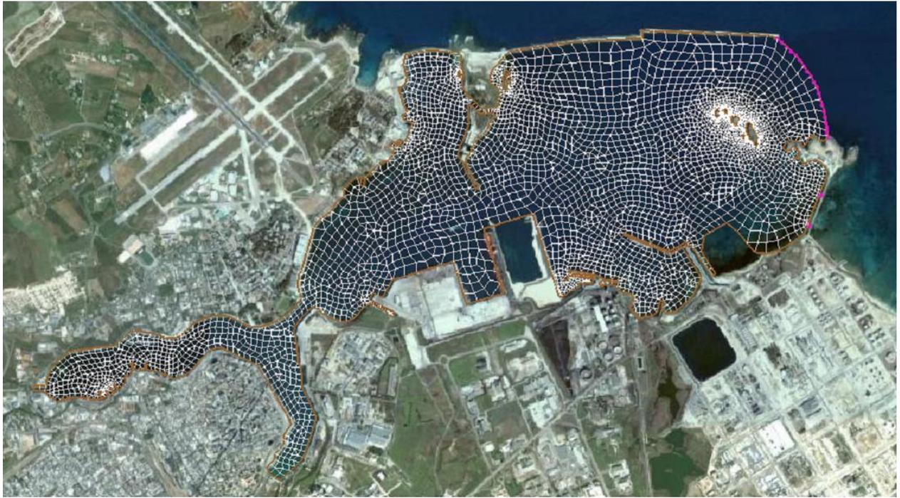
Figura 2.3 – Griglia di calcolo: configurazione attuale.
