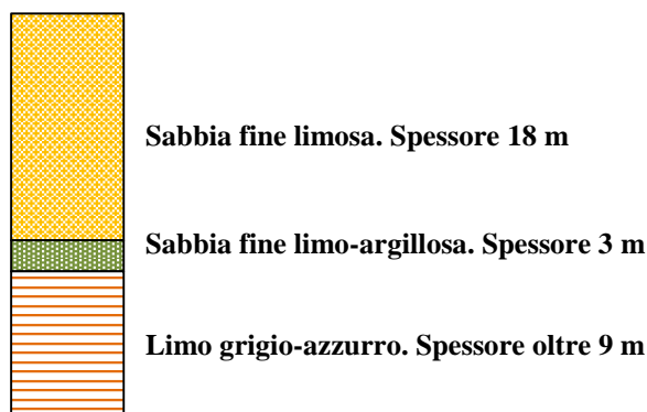
Fig. 18 – Colonna stratigrafica ricavata dai sondaggi realizzati a mare.
