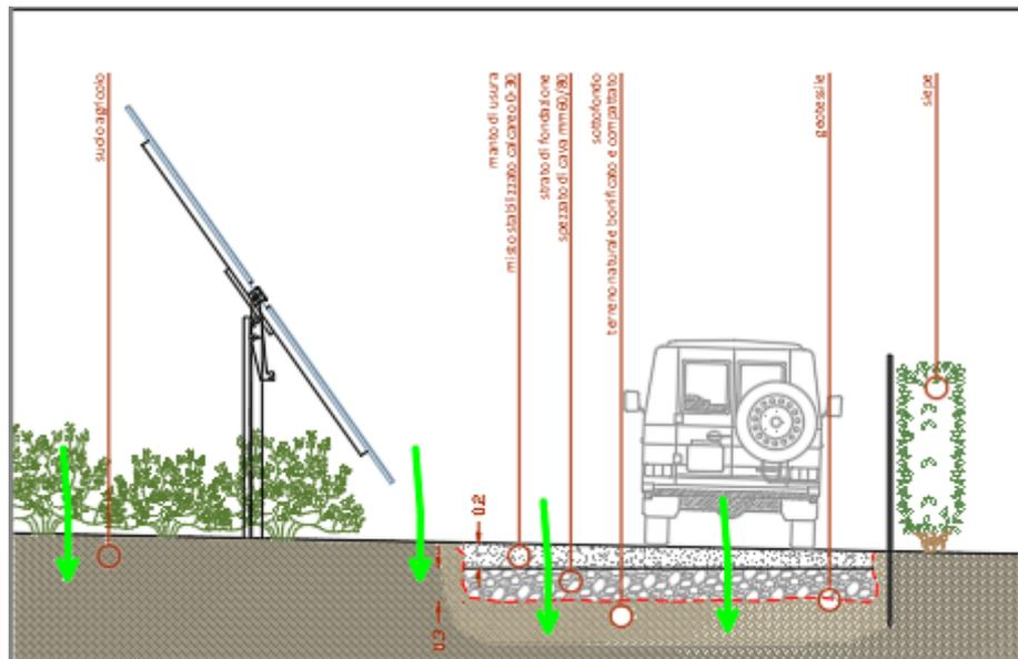
**Figura 26 – Viabilità interna al parco: assorbimento delle precipitazioni**
