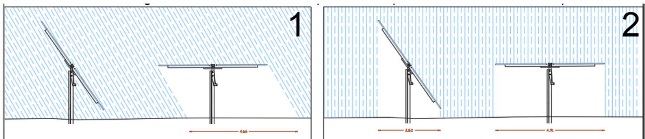
Figura 24- Impronta a terra dei Tracker in funzione della direzione di pioggia
