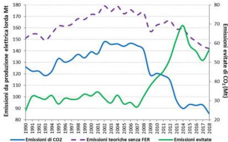
**Figura 15 - Andamento delle emissioni effettive per la produzione lorda di energia elettrica e delle emissioni teoriche per la produzione di energia elettrica da fonti rinnovabili con equivalente produzione da fonti fossili.**
