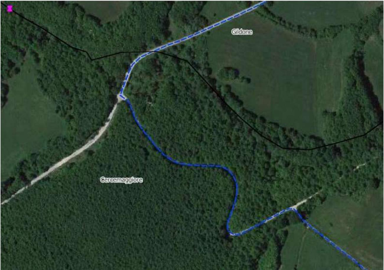
Ortofoto con riportato il tratto di cavidotto da interrare sulla viabilità esistente all'interno del bosco Pesco Sambuco
