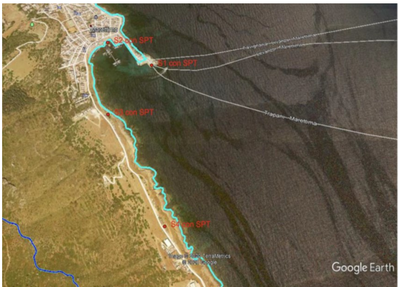
Figura 17 - Ubicazione sondaggi geognostici in foro con SPT
