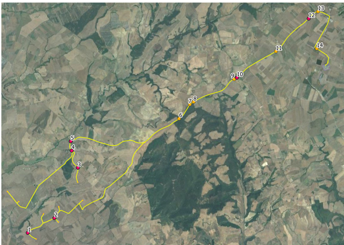
Figura 3.1: Tracciato del cavidotto interrato di connessione
