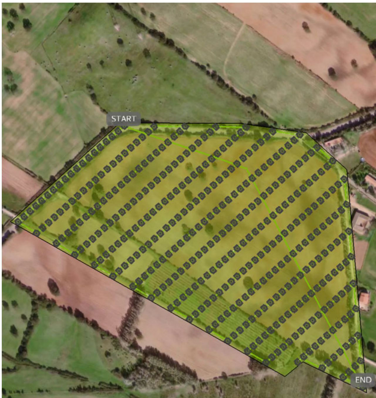
Figura 4 – Esempio di pianificazione di una missione di volo Pix4D capture (Cossu)
