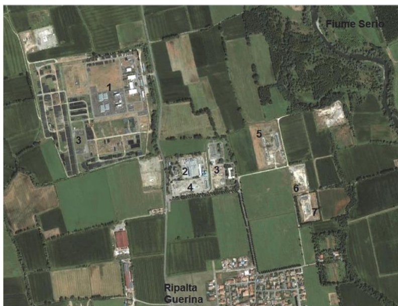
Figura 1. Principali infrastrutture della Concessione Ripalta Stoccaggio nella situazione impiantistica attuale (base: Google Earth): (1) impianto (area) di compressione; (2) attuale impianto (area) di trattamento; (3) aree Snam Rete Gas; (4) cluster A; (5) cluster C; (6) cluster B; (7) cluster D.
