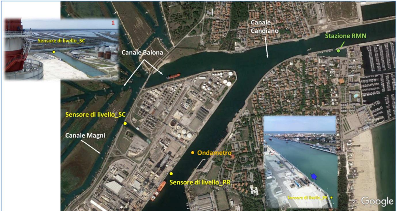
Figura 3 - Dettaglio della localizzazione dei sensori per il monitoraggio dei corpi idrici nell'area di Centrale
