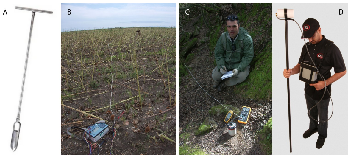
Figura 3.3.a – A: Campionatore Suoli ( auger ); B: Stesa cavi per geoelettrica; C: Misura di Potenziali Spontanei; D: Magnetometro in configurazione operativa.
