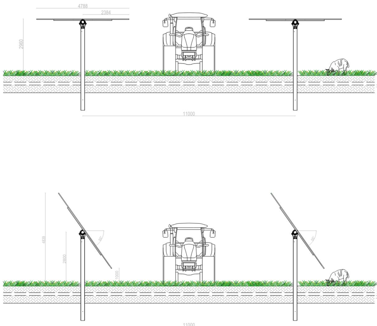
Figura 7.1 - Disposizione degli inseguitori solari e spazi utili per le lavorazioni agricole
