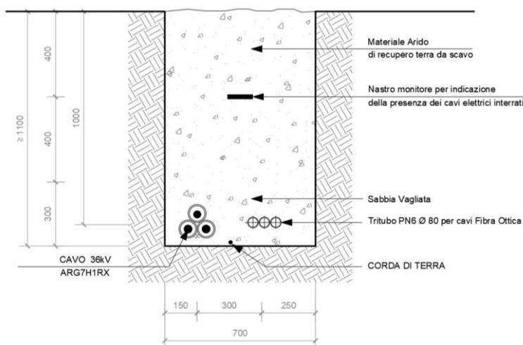
Figura 7.8 – Tipico modalità di posa cavo 36 kV
