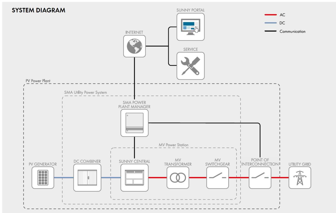
Figura 7.10 – Schema elettrico tipologico dell'Unità di conversione e trasformazione
