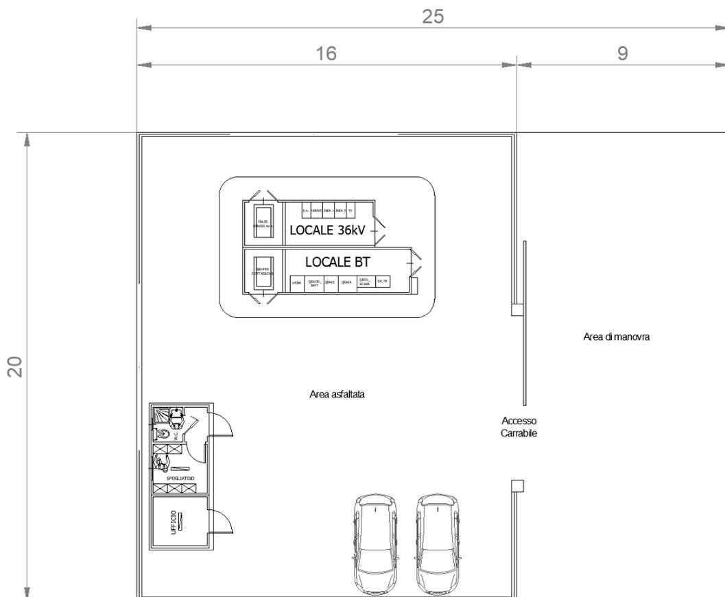
Figura 7.5 - Planimetria Cabina Elettrica Utente
