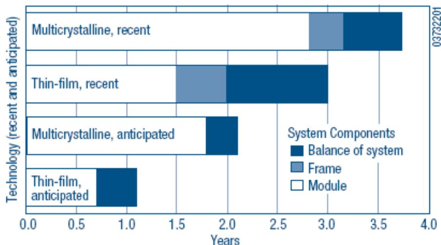
Figura 6.3 – Variazione dell’Energy payback per le diverse tecnologie di sistemi fotovoltaici (Fonte, U.S. Dep. of Energy)
