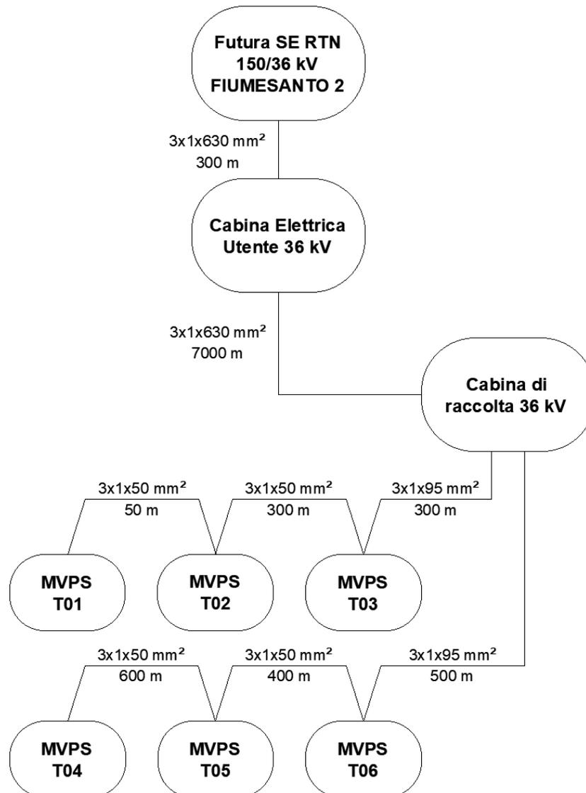
Figura 7.4 – Schema a Blocchi Impianto FV
