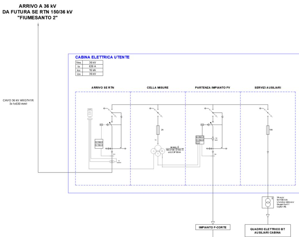
Figura 7.6 - Schema elettrico unifilare Quadro Cabina Elettrica Utente
