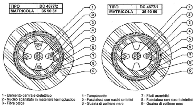
Figura 5.1 – Cavo fibra ottica secondo specifica DC 4677
