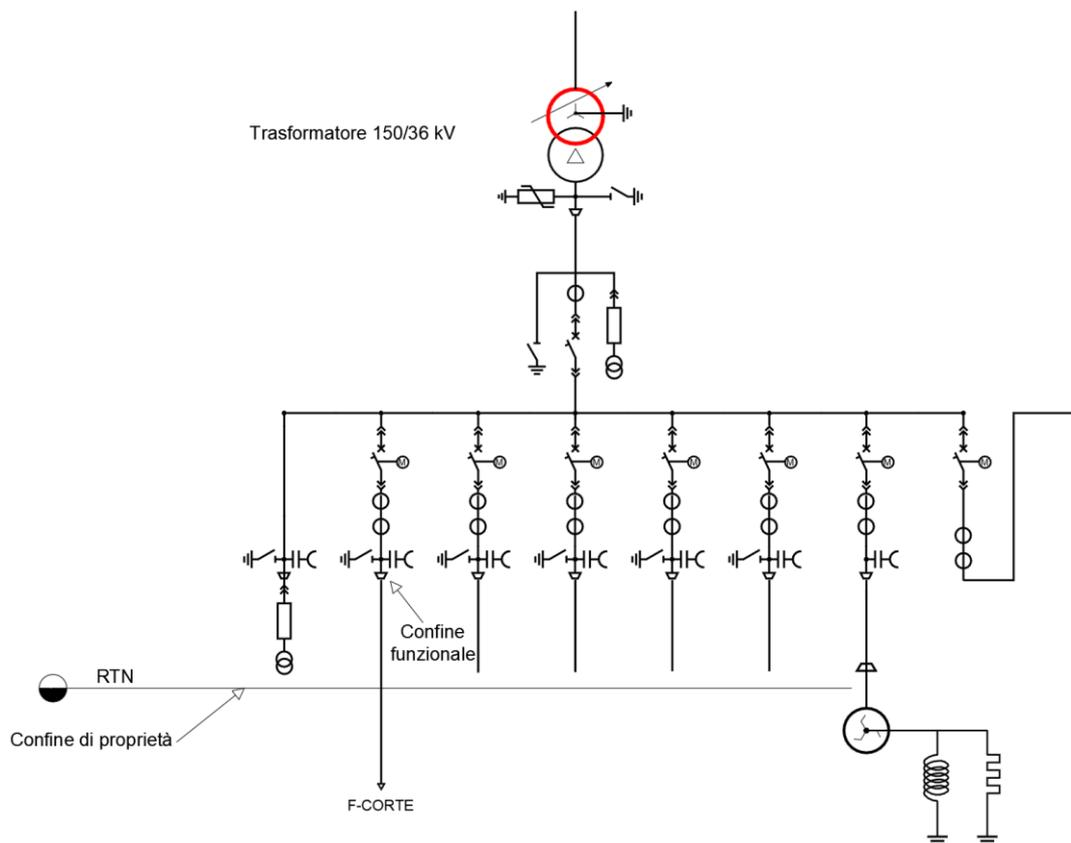
Figura 2.1 – Schema connessione agli stalli di consegna TERNA
