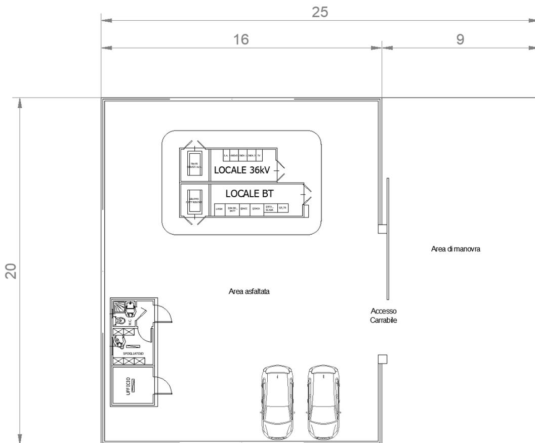
Figura 3.1 - Planimetria Cabina Elettrica Utente
