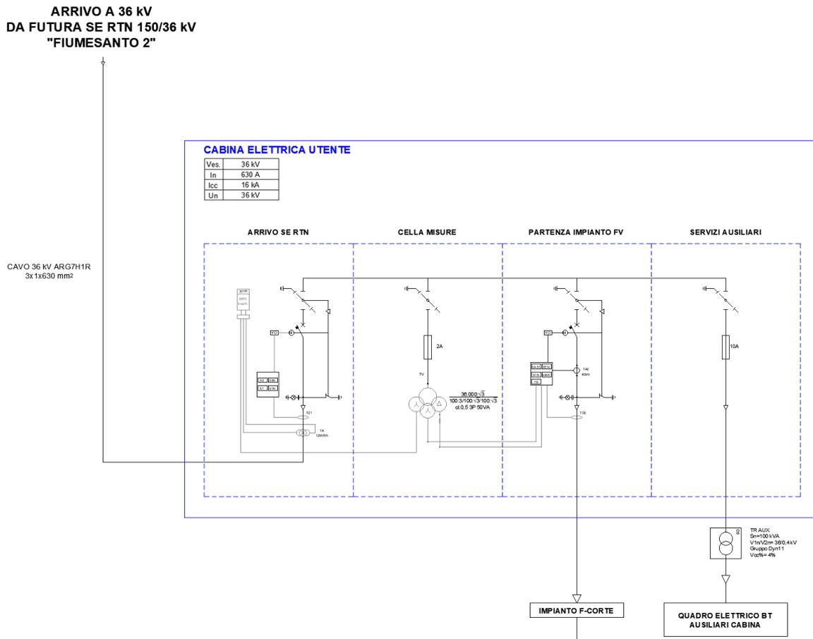
Figura 3.2 - Schema elettrico unifilare Quadro Cabina Elettrica Utente
