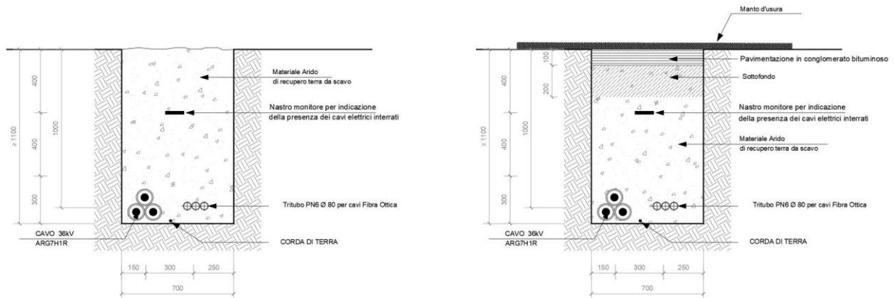
Figura 4.2 – Tipico modalità di posa cavi a 36 kV
