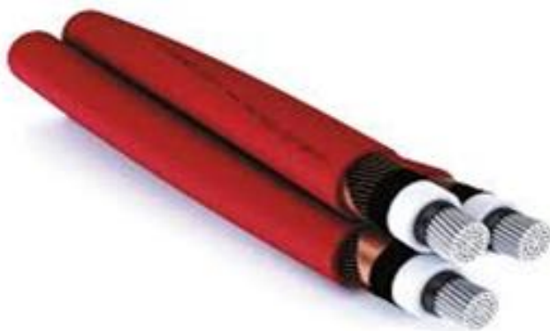
Figura 5.7 - Cavo del tipo ARG7H1RX tripolare ad elica visibile
