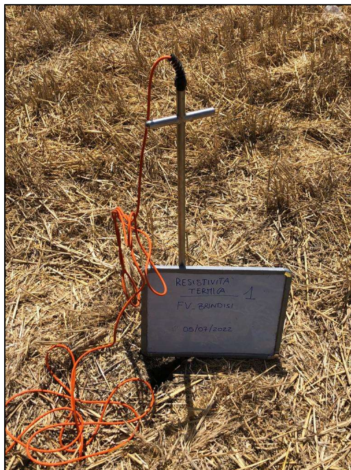
Strumentazione utilizzata per test di resistività termica
