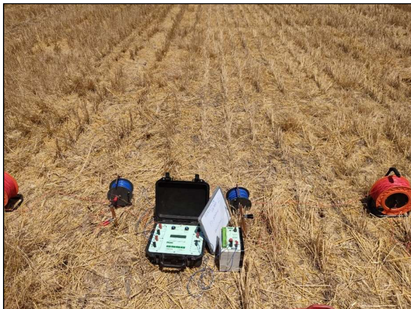
Stendimento per test di resistività elettrica
