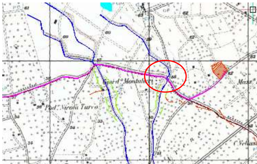
Figura 19: Carta idrogeomorfologica AdB Puglia interferenza con reticolo idrografico n. 5 (in magenta il percorso del cavidotto).
