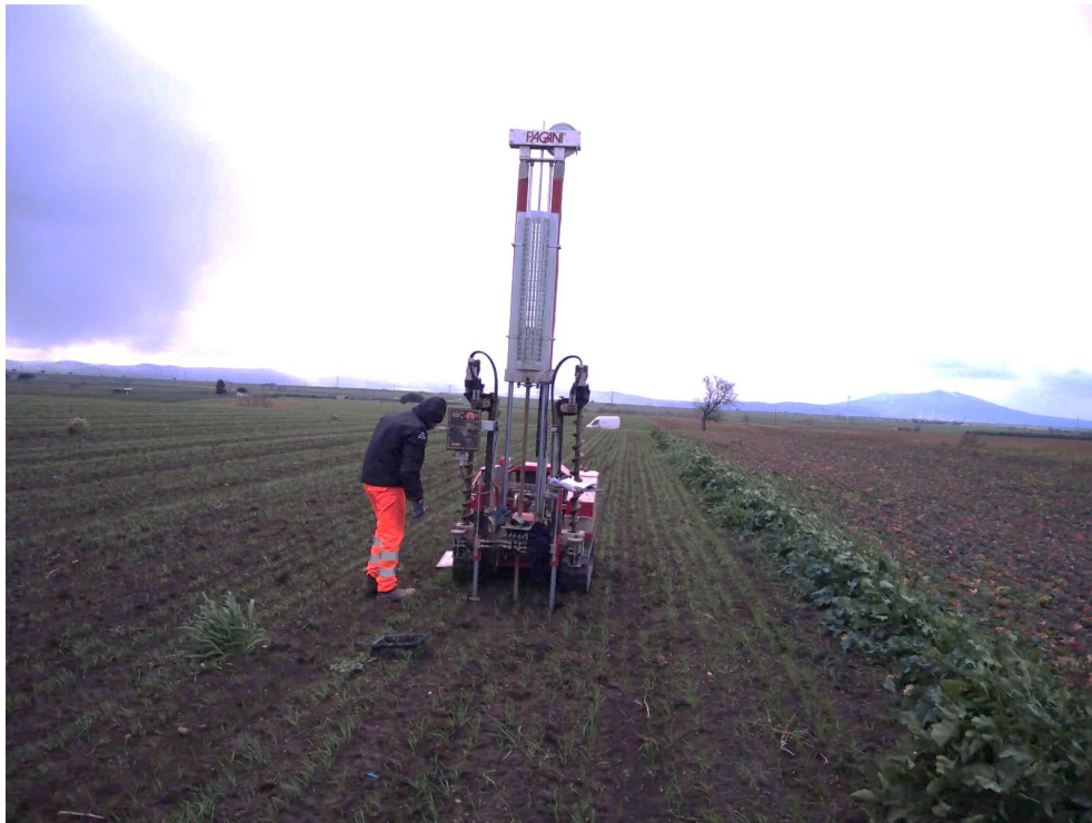
Prova Penetrometrica Dinamica Pesante DPSH 03
