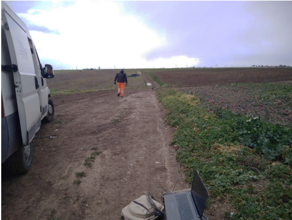
Indagine sismica di superficie Masw M1
