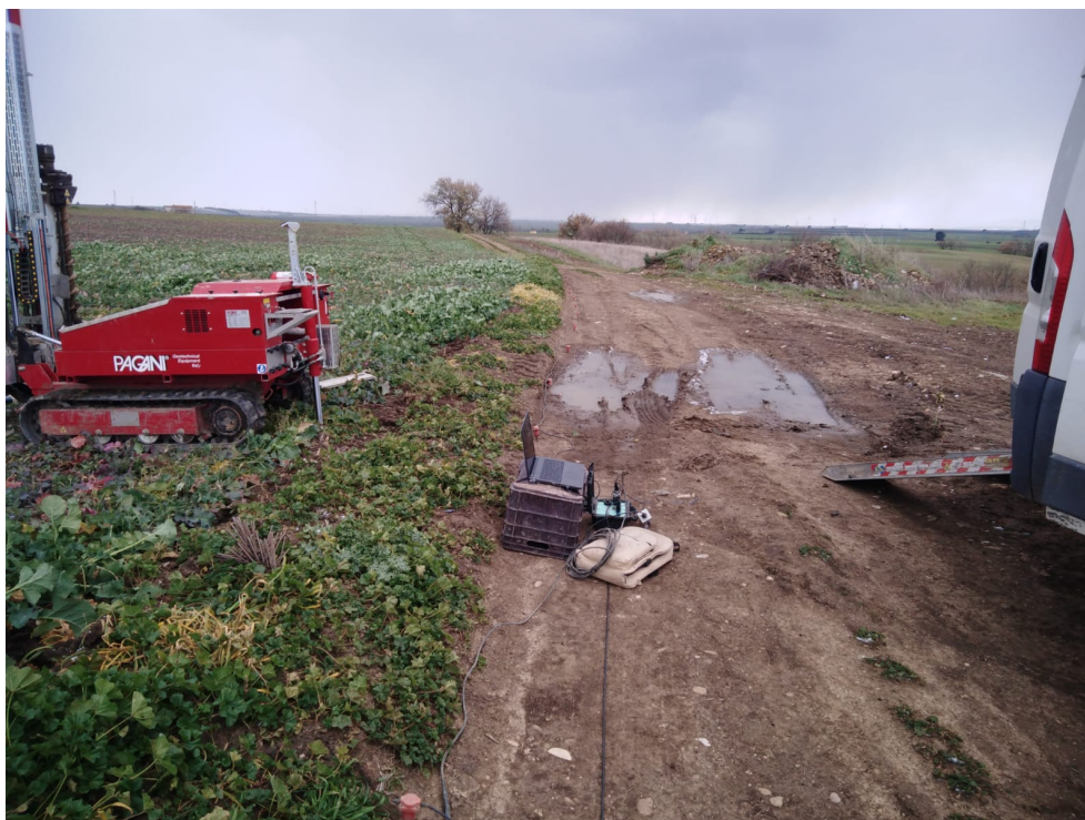
Indagine sismica di superficie Masw M1
